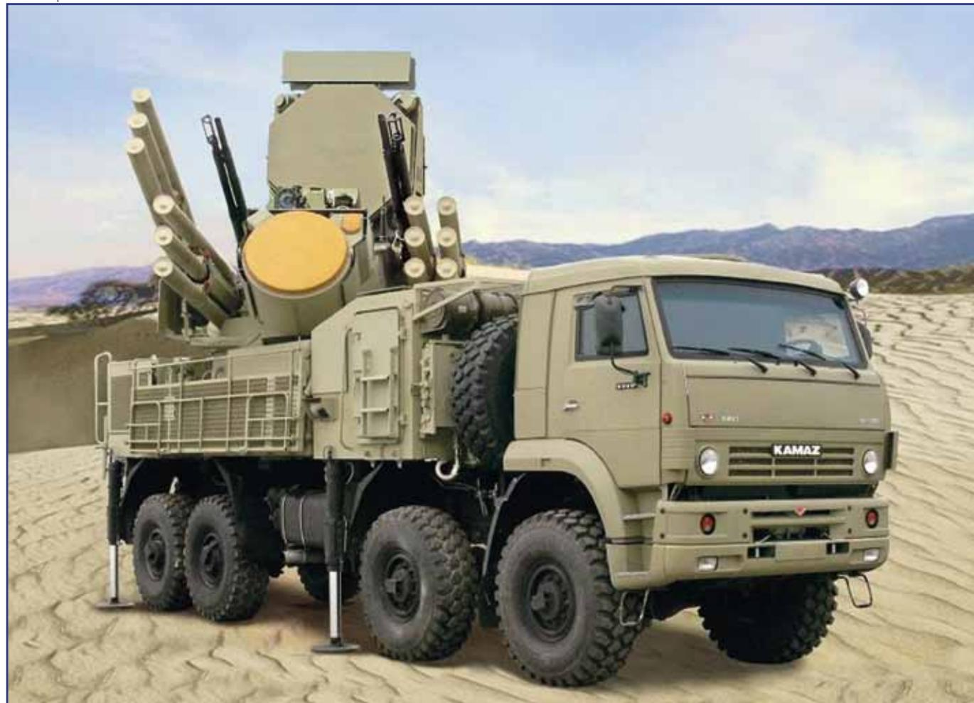
Estabilizado no terreno, sobre sapatas/macacos hidráulicos, a precisão do Pantsir-S1 fica acrescida de, no mínimo, 10%. Na foto, vê-se todo o sistema com seus dois canhões duplos de 30 mm e 12 lançadores de mísseis, o radar de busca/detecção ESA Janus-faced, elevado e à retaguarda, o radar multifuncional de acompanhamento/tiro IRS2-E, com antena amarela, e, acima desse, o sistema ótico-eletrônico (SOE).
