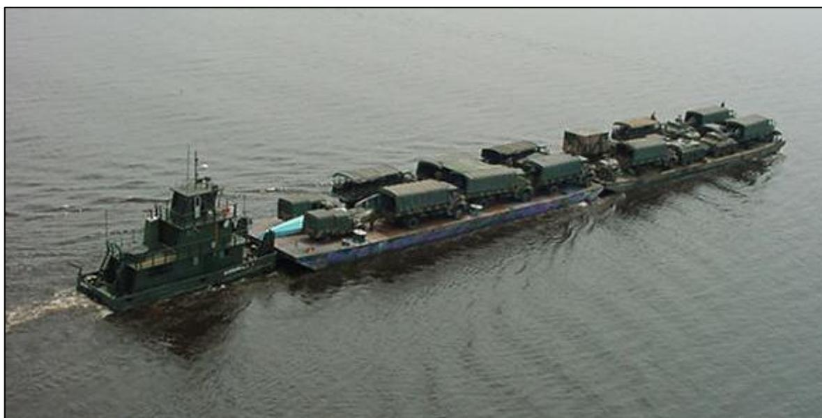
Figura 44 – Composição de balsas com empurrador.
