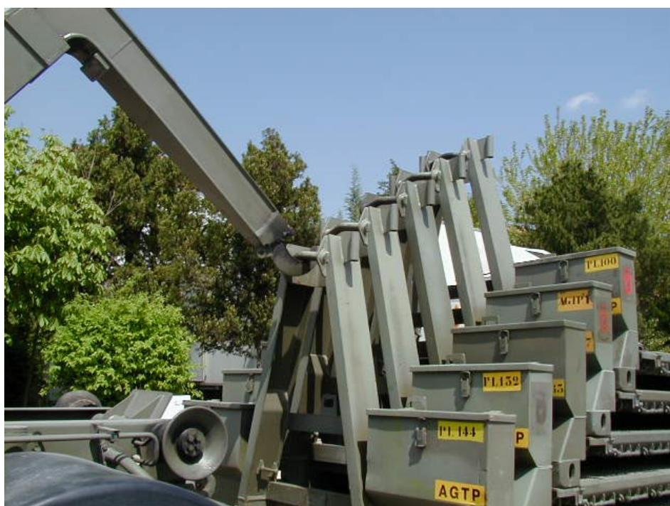
Figura 8 – Visão detalhada do encaixe das plataformas de carga. Para facilitar o transporte e a armazenagem, várias delas podem ser empilhadas.
