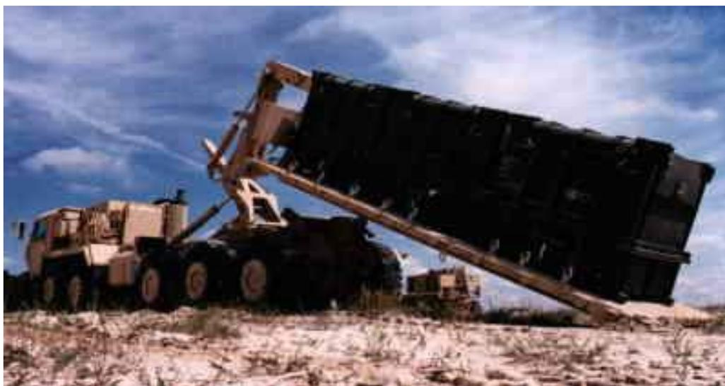
Figura 2 – Sistema de carga paletizada (Palletized Load System - PLS), pertencente ao exército norte-americano. Tem capacidade para transportar 16,5 toneladas em qualquer terreno. Pode receber um reboque, com a mesma capacidade de carga, perfazendo um total de 33 toneladas. É considerado **um componente chave de transporte do sistema de distribuição de munições daquele exército.**
