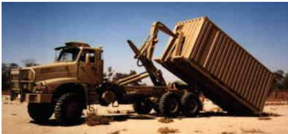
Figura 1 – Viatura de transporte especializado, com braço hidráulico para o levantamento da carga unitizada (plataforma de carga).
