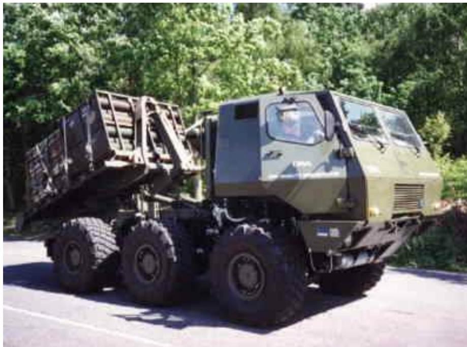
Figura 4 – Viatura de transporte especializado, pertencente ao exército inglês. Observa-se o suprimento unitizado de munições na plataforma de carga.
