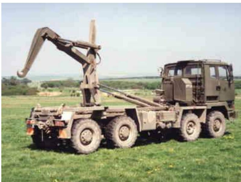
Figura 4 – Visão aproximada do sistema de braços hidráulicos responsável pelo levantamento da carga.
