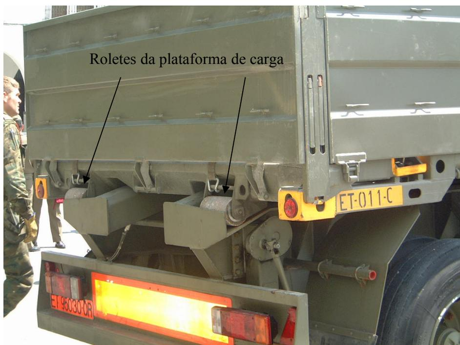
Figura 7 – Visão detalhada dos roletes existentes nas plataformas de carga
