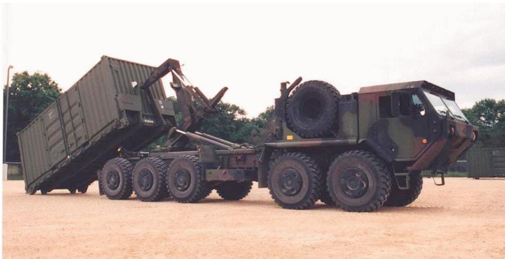
Figura 3 – Outra visão da Viatura PLS, onde se pode observar o levantamento de um contêiner de 20 pés.
