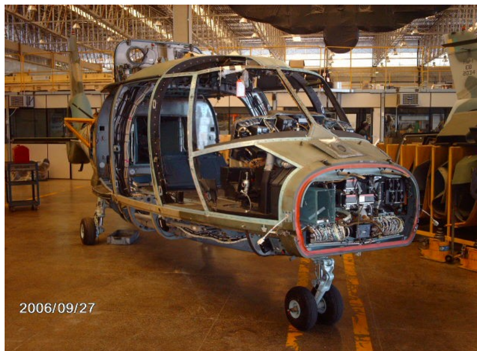
Figura 31: Aeronave HM-1 Pantera em Grande Inspeção no B Mnt Sup Av Ex Fonte: autor
