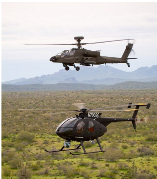
FIGURA 53: VANT Little Bird, equipado com meios de GE, sendo controlado da aeronave Apache. Fonte: Disponível em :< http://www.army-technology.com/projects/littlebirdhelicopter/ >. Acesso em 21 de novembro de 2011.
