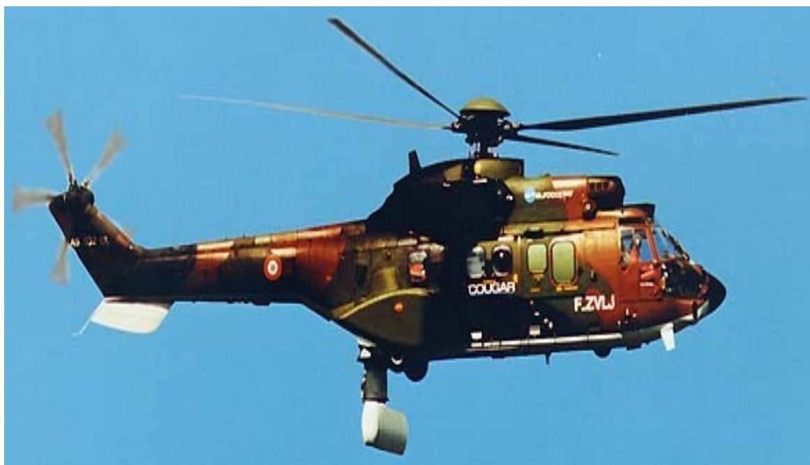
Foto 41: Aeronave AS 532 UL Horizon, equipada com meios de GE Fonte: Disponível em :< http://www.army-technology.com/projects/horizon/horizon1.html >. Acesso em 21 de julho de 2010.
