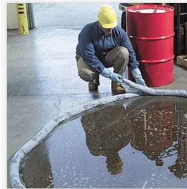
Barreira realizando a contenção do material oleoso
