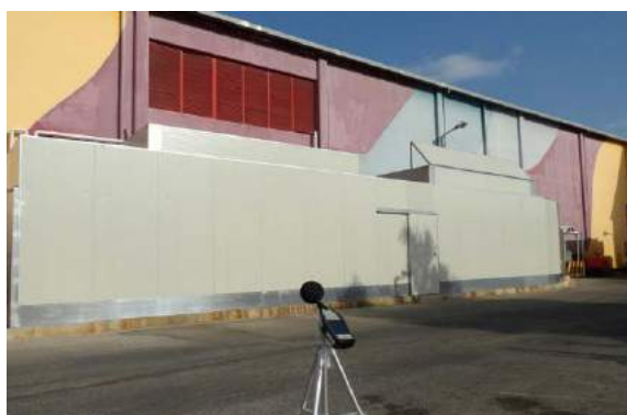
Figura 2 - Correto posicionamento do decibelímetro na análise da fonte emissora para o diagnóstico dos ruídos ambientais
